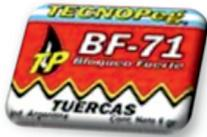
**Bloqueo Fuerte de tuercas y bulones. Muy resistente a combustibles. Para roscas de hasta 1" diam. Desarme: Herramientas especiales (extractores, presas)**
